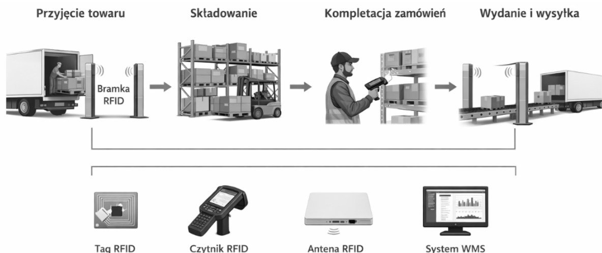
Rysunek 2. Proces magazynowy z wykorzystaniem technologii RFID
