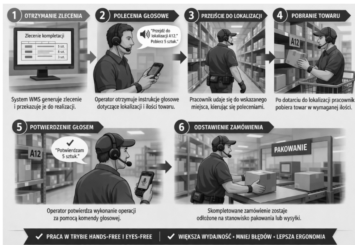
Rysunek 7. Proces kompletacji zamówienia w systemie Pick-by-Voice
