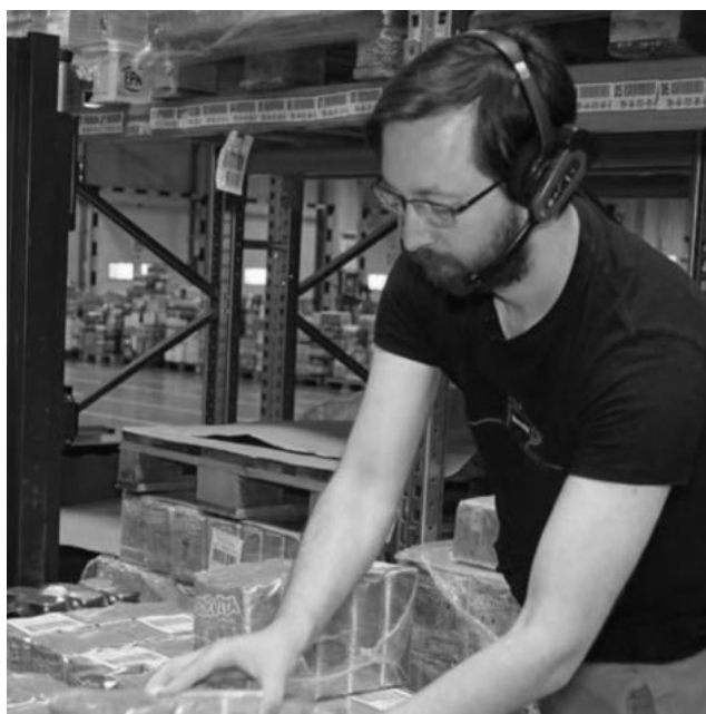
Zdjęcie 2. Zastosowanie technologii Pick-by-Voice.
