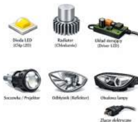
Rys. 29. Elementy składowe lampy LED
